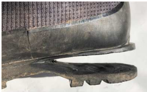
劣化した灰色のミッドソールを除去
