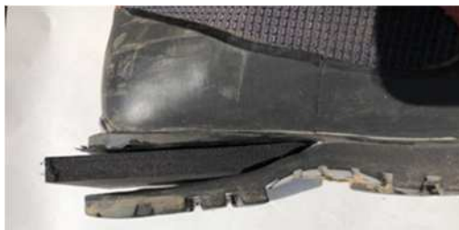
新しいNBRスポンジを挟み込む
